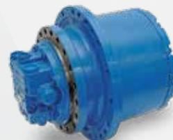
Ciascun cingolo è azionato da un motore di traslazione con cambio automatico a 2 velocità e freni a dischi multipli con innesto a molla e a rilascio idraulico. La velocità di traslazione non ha confronti e arriva fino a 5,2 km/h.
